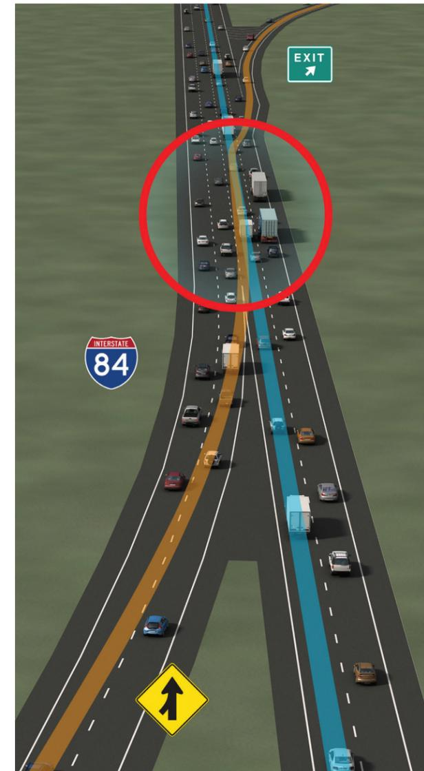
Rampas mal posicionadas significam entrelaçamento entre elas
