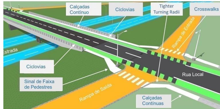
O planejamento multimodal próximo a uma rampa da rodovia pode envolver a criação de calçadas contínuas, travessias mais seguras e uma iluminação melhor para aprimorar as viagens de todos os usuários da rodovia. O gráfico à esquerda exibe uma rampa com conexões multimodais ruins. O gráfico à direita exibe uma rampa com conexões multimodais aprimoradas.
